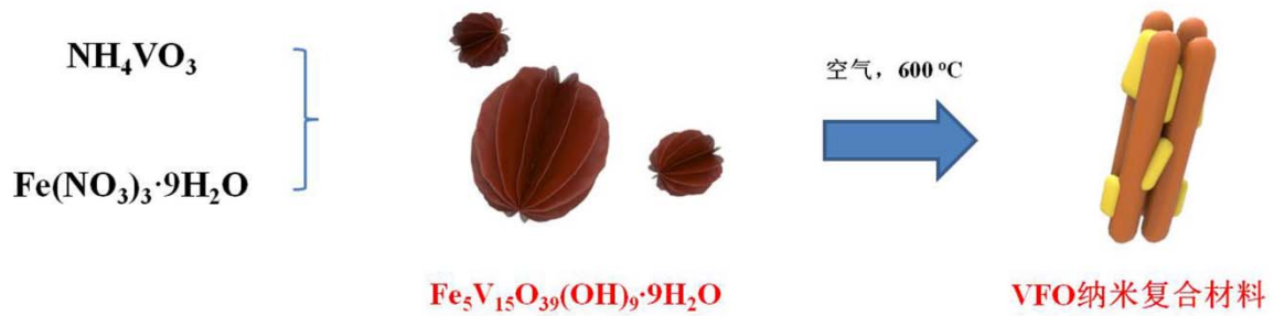
图 S3 VFO 的合成示意图 Fig. S3 Schematic illustration of the preparation of VFO.
