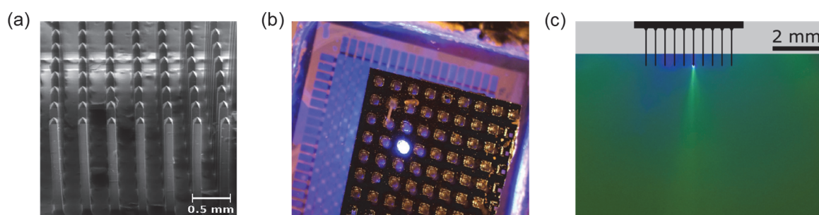
图5 (a)犹他光电极阵列 36 ; (b)光传导器限制光在一个电极中传播 38 ; (c)光电极在荧光素溶液中的传播 38
